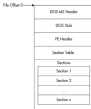
Figure 2.2: PE header structure
